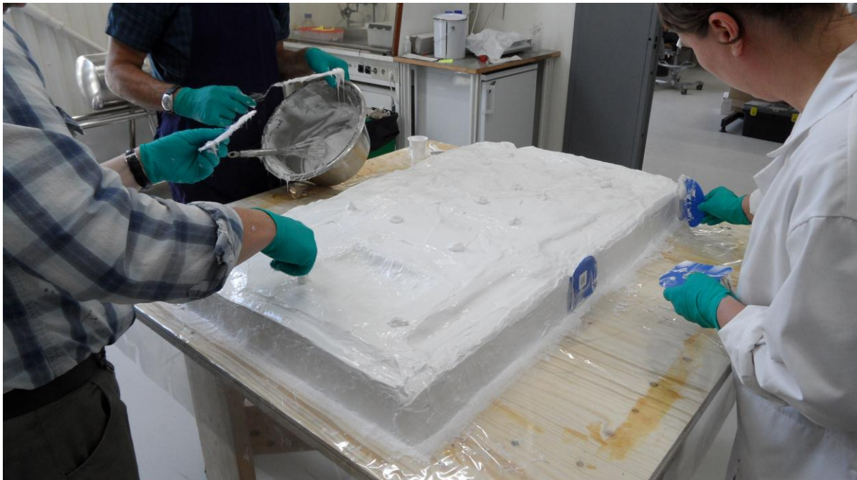
Bilden visar tredje skinnet och knopparna som ska låsa silikonformen i gipskappan.
