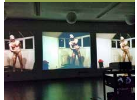
Avfotograferad uppställning med tre olika projektorer för Sam Taylor Woods Brontosaurus, t.v. CRT, mitten LCD och t.h. LCoS.
