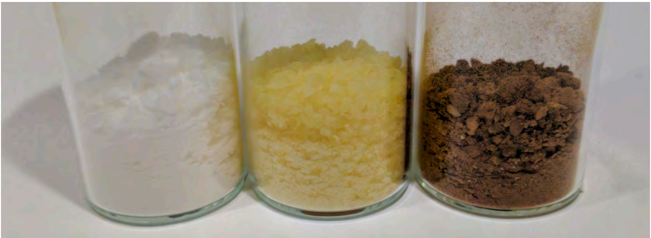
Det nya lovande kiselmaterial – tre olika blandningar av kiseldioxid och polymer. Förhoppningsvis kan materialet integreras i montrar och förvaringslådor och förhindra att föremål skadas av sura gaser. Foto: Elyse Canosa (CC BY).
