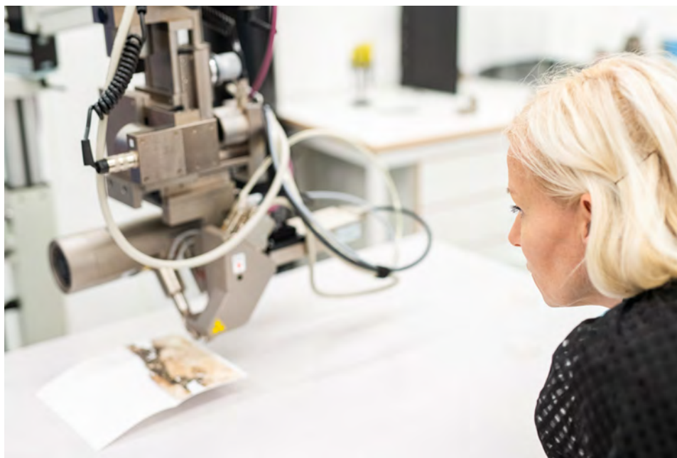
Grundämnesanalys med hjälp av \mu XRF Foto: Johanna Åkerberg Kassel (CC BY).
