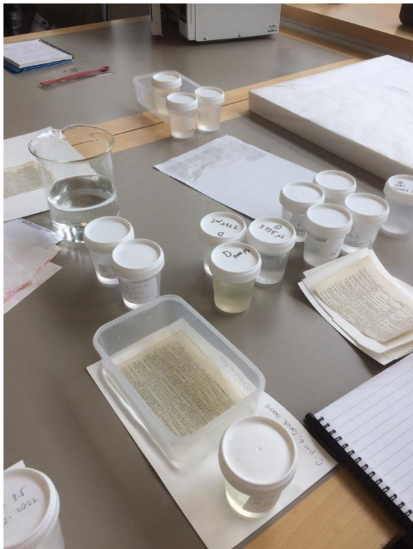
Testlösningar med olika pH och komplexbildare.
