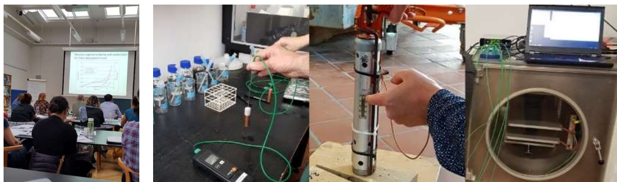
Bild 1-4. Teori på förmiddagarna och praktiska övningar på eftermiddagarna. Här testas polyetylenglykolens smältpunkt (bild 2). Träets mjukhet testas med en pilodyn (bild 3) och olika PEG koncentrationers infrysningskurvor undersöks (bild 4).
